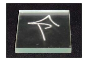
Möglich ist das Markieren per Wasserstrahl bei Oberflächen aus Metallen aller Art, Kunstund Verbundstoffen, Stein sowie Glas – je nach Bedarf mit oder ohne Abrasiv. Die
